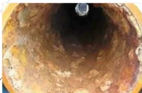
古い水道管（鋳鉄管）の内部
