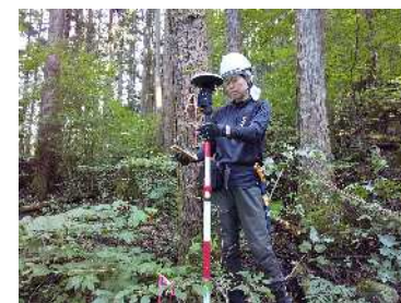
GNSS 測量機による高精度な測量
